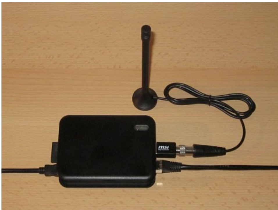
HAMServerPi: RaspberryPi mit DVB-T-Stick (z.B. für APRS-Empfang) hamserverpi.jpg (47.19 KiB) 858-mal betrachtet
