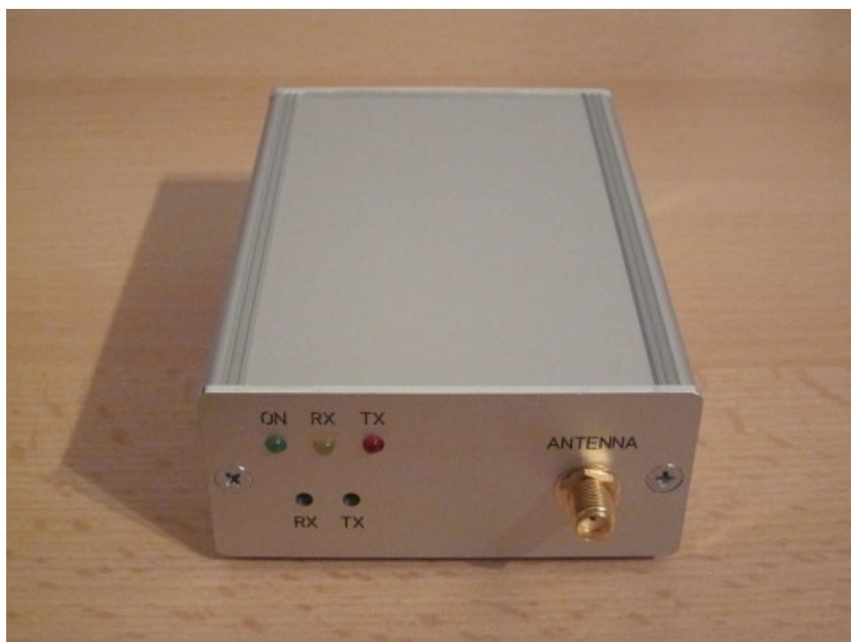
HAMServerPi RadioBox: Mit VHF- oder UHF-Modul und Antennenbuchse radiobox.jpg (114.17 KiB) 26-mal betrachtet
